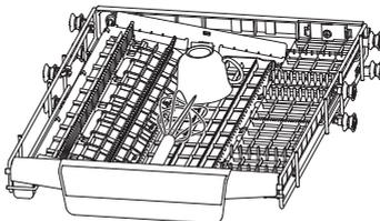
3. Чтобы отрегулировать высоту стойки, ослабьте четыре защелки на лотке и осторожно нажмите на них.
