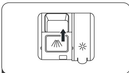
3. Закройте крышку отсека
