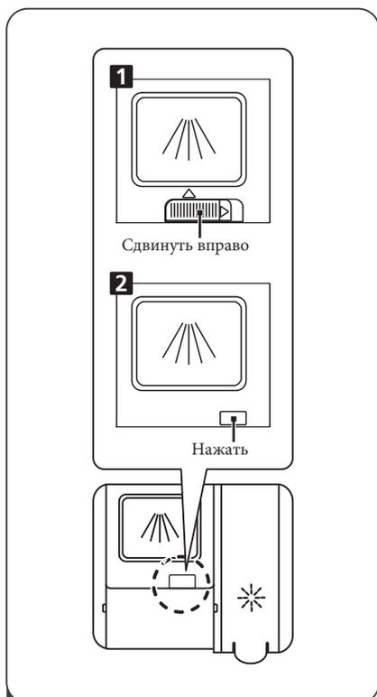
1. Сдвиньте (\*) фиксатор для открытия отсека
