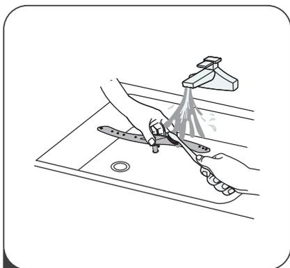
**3** Промойте разбрызгиватель теплой водой с мылом и очистите форсунки мягкой щеткой. Установите разбрызгиватель обратно после тщательной промывки.
