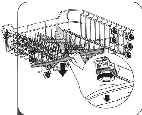
**1** Чтобы снять верхний разбрызгиватель, удерживайте гайку в центре неподвижно и поверните разбрызгиватель против часовой стрелки, чтобы снять его.
