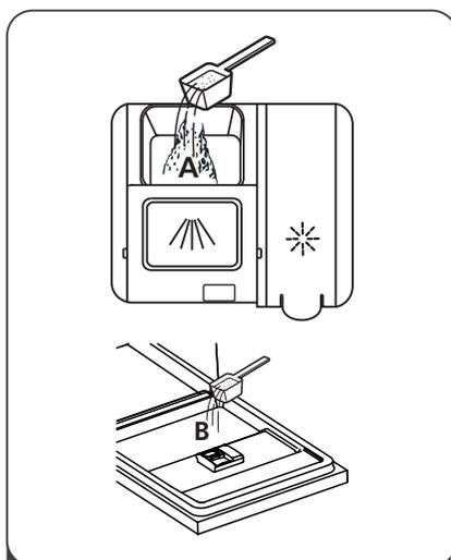
2. Добавьте моющее средство в большую полость (А) для основной стирки. Для более сильно загрязненной загрузки добавьте немного моющего средства в меньшую полость (В) для его высвобождения во время предварительной стирки.
